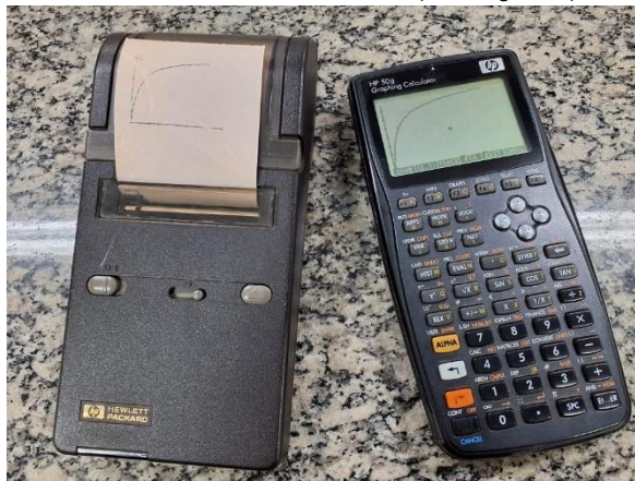
Figura 1: Calculadora gráfica Hewlett-Packard HP50G e impressora com sensor infravermelho 82240B. A tela gráfica e sua impressão apresentam uma simulação para dados de isoterma de adsorção de Langmuir e ajuste não linear de Gauss-Newton a um complexo ligante-proteína.
